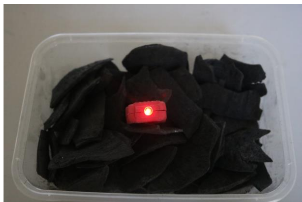
Hình 6. Than hoạt tính thu được từ nghiên cứu thực nghiệm Bảng 1. Các đặc tính của than hoạt tính từ gáo dừa
