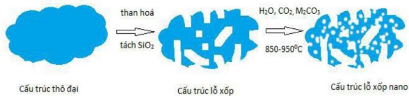
Hình 1. Quá trình sản xuất than hoạt tính
